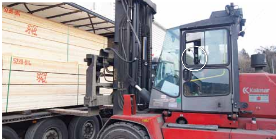
Stapler beladen einen Lkw mit Leimbinderlamellen von Rubner Holzindustrie – ein Mobilcomputer in der Kabine ist Anzeige und Scanner zugleich (im Kreis)
