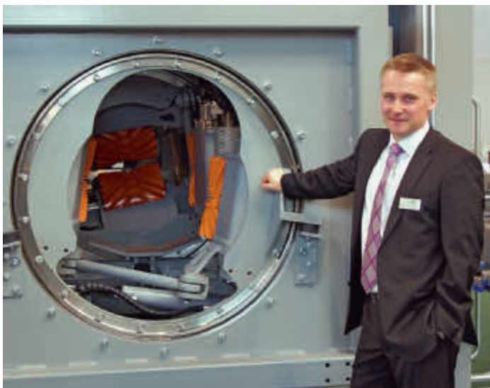
Bis zu 200 m/min Vorschub, aber hochpräzise: Tuomo Kauppinen von Veisto zeigte auf der Ligna die neue Doppelrotoreindrehung
