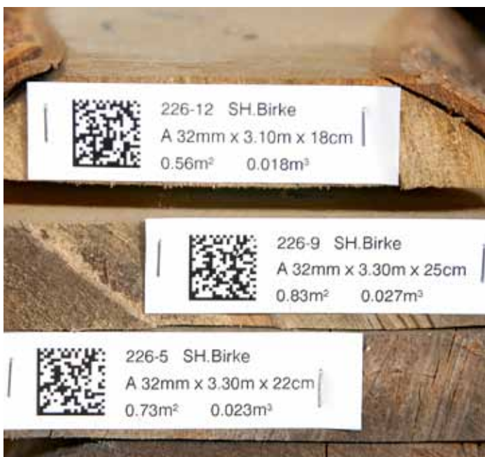
Jedes Brett ist mit einem Barcode versehen – die Zettelhöhe passt sich automatisch der Brettstärke an
