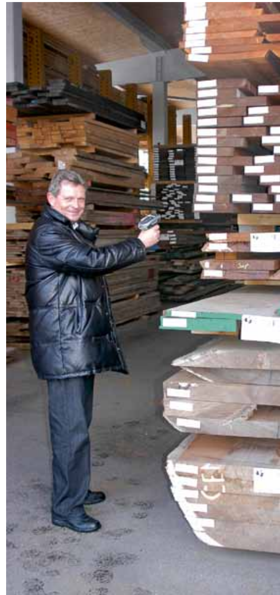
Schnelle Erkennung der Barcodes mithilfe eines mobilen Handscanners
